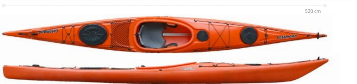
Der Meridian ist ein echter Allrounder. Seine lange Wasserlinie sorgt für eine hohe Reisegeschwindigkeit. Dank des ausgeprägten U-Spans ist der Meridian trotzdem sehr wendig, womit er sich trotz seiner 520 cm auch für kleinere Flüsse eignet. Die robuste PE-Bauweise treibt dir auch bei Grundkontakt oder an
